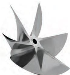
**CNC Cleaver, закаленная нержавеющая сталь, 6-лопастный с 21-град. наклоном (1200 л.с.)**
